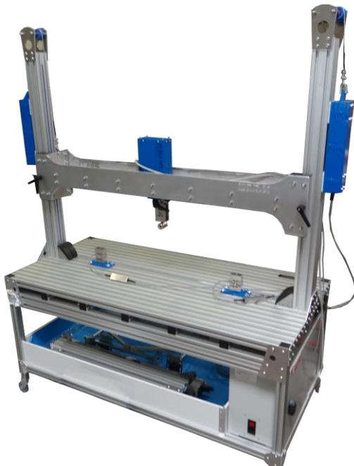
La machine de **caractérisation des structures** permet de réaliser des études de résistances de matériaux (RDM) et de structures. Les essais sont possibles en **traction, compression** avec le logiciel de commande et d'acquisition fournie.
