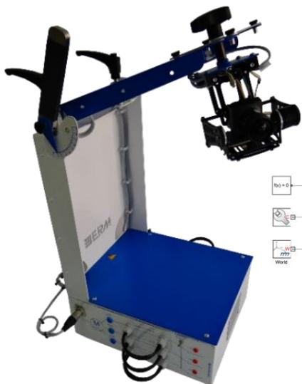
Le système didactique **Nacelle de prise de vue** aérienne est monté sur un **banc d'essai** permettant des **études mécaniques** et **d'asservissement**. Il est issu d'une véritable nacelle asservie montée sur un drone.
