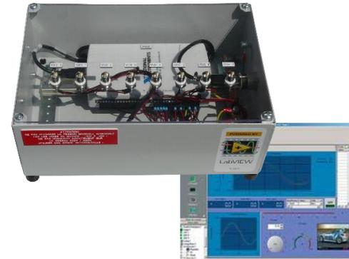
La **centrale d'acquisition USB** est un appareil permettant d'**acquérir des grandeurs physiques** à partir de capteurs de température, de tension, de courant,... et **de les afficher** facilement à l'aide du logiciel **LabVIEW** ou **Sysma WinATS**
