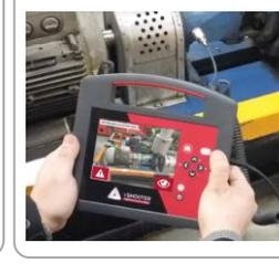
**Instrumentation de mesure d'alignement de poulies et tension de courroies**
