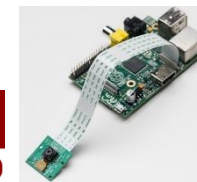
PR05 - Kit de développement RaspBerry avec caméra et microphone
