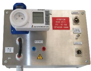
Coffret de mesures
