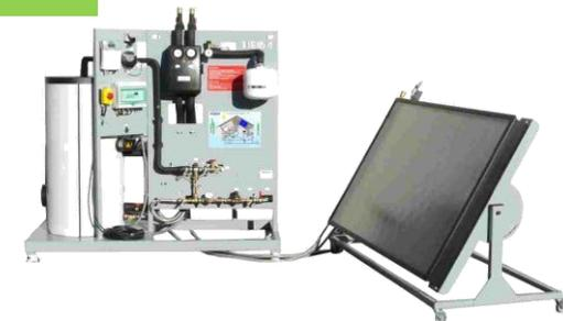
Plate-forme modulaire d'étude des solutions « résidentiel » et « petit tertiaire » de production, distribution et émission de chauffage / rafraîchissement
