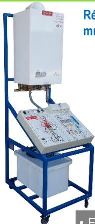
Réglages gaz, paramétrages de régulation et dépannage d'une chaudière murale gaz
