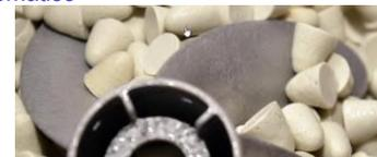
**Post Process Deci Duo (Retrait du support et Polissage de surfaces automatisés)**
