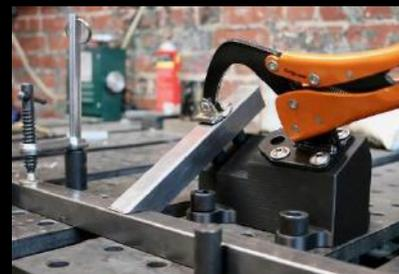
Fixations de soudure
