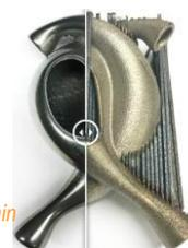
**GPA Innova Drylite (Electro-polissage de surfaces)**
