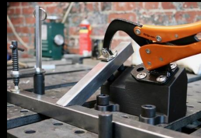
Fixations de soudure MarkForged: 60€ - Usinage: 500€
