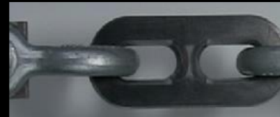
Maillon de chaîne imprimé avec fibre longue de carbone: 11 tonnes en traction avant rupture
