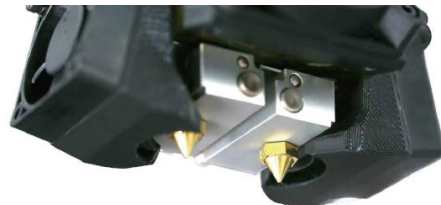
Deux têtes rétractables électroniquement
