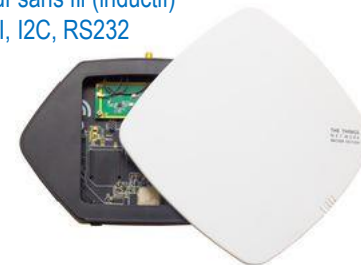
PR22 – Passerelle LoRa WAN « The Things Network »
